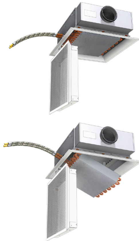
Billede 3. Batteriet er nedfældet for inspektion, vedligeholdelse og rengøring af de indre dele.
