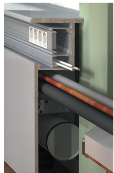
Billede 7. Beklædning med fast vindueskarm og synlig elkanal.
