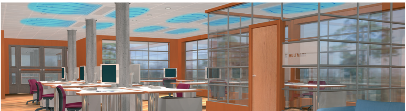
Billede 6. Et separat kontor skal passes ind i rummet. Hvis klimaet skal være optimalt, skal luftmængden og luftfordelingen justeres på Premum bafflen, der bygges ind i det nye rum.
